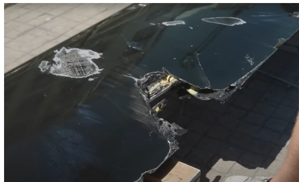
Figure 2: Dérive du bateau SVR-Lazartigue après une collision probable avec un cétacé
